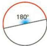
$$l_{\text{arco}} = \frac{2 \cdot \pi \cdot r}{360^\circ} \cdot \hat{A} \Rightarrow l_{\text{arco}} = \frac{2 \cdot 3,14 \cdot 5}{360^\circ} \cdot 180^\circ = 15,7 \Rightarrow l_{\text{arco}} = 15,7 \text{ cm}$$
